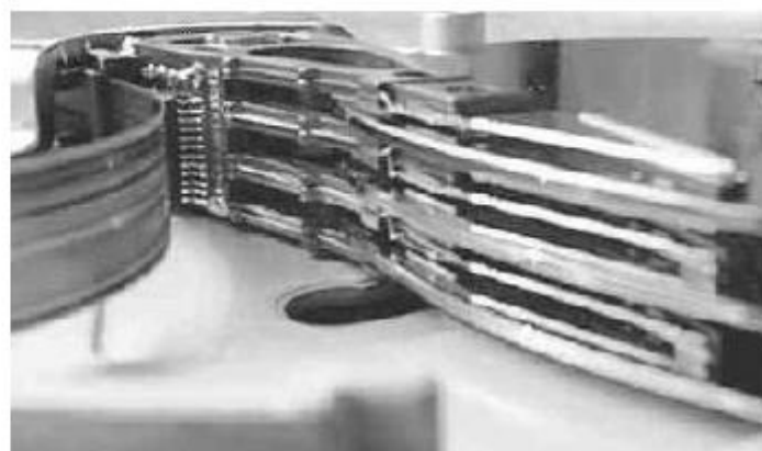
Sl.9.8 Položaj glava za čitanje/pisanje u odnosu na diskove.
